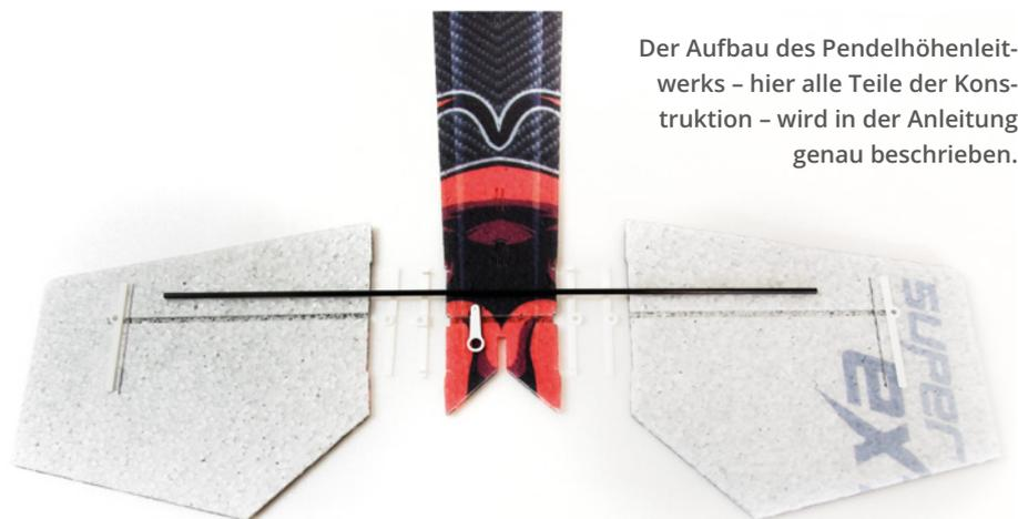
Der Aufbau des Pendelhöhenleitwerks – hier alle Teile der Konstruktion – wird in der Anleitung genau beschrieben.
