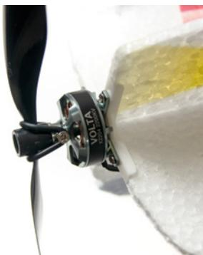
Genug Kraft für alle Manöver: Beim Testmodell ist der von Voltmaster empfohlene Volta X2204/2200 montiert.
