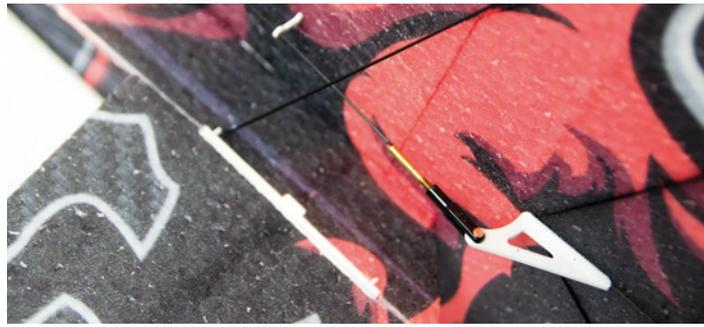
Bei den Anlenkungen – hier das Seitenruder – kommen 3D-Druckteile zum Einsatz. Gabelköpfe mit Gewinde ermöglichen die Feineinstellung.
