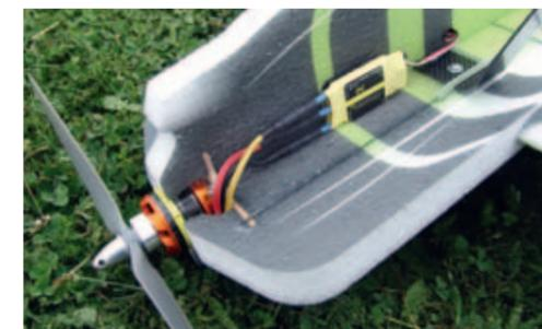
Der Torcster ECO BEC 30A V.2 passt sehr gut zu Antrieb und Modell. Vor der Inbetriebnahme sollte das niedrige Timing für den Außenläufer auf den höchsten Wert umgestellt werden
