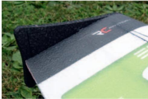
Winglets schließen die Querruder nach außen hin ab, reduzieren den induzierten Widerstand und helfen beim Messerflug
