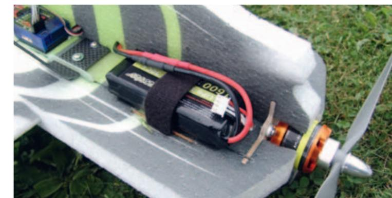
Die ursprüngliche Positionierung für den angegebenen Schwerpunkt sah den Antriebsakku möglichst weit vorne
