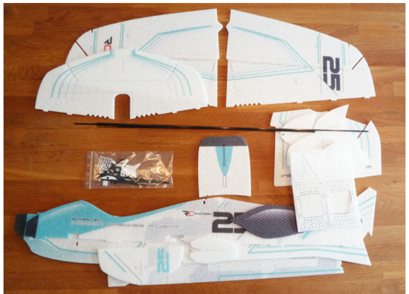
Der Inhalt des Baukastens: Verschiedene, bereits farblich bedruckte Bauteile aus 4-Millimeter-EPP, einige längere CFK-Leisten sowie ein Beutel mit verschiedenen Kleinteilen
