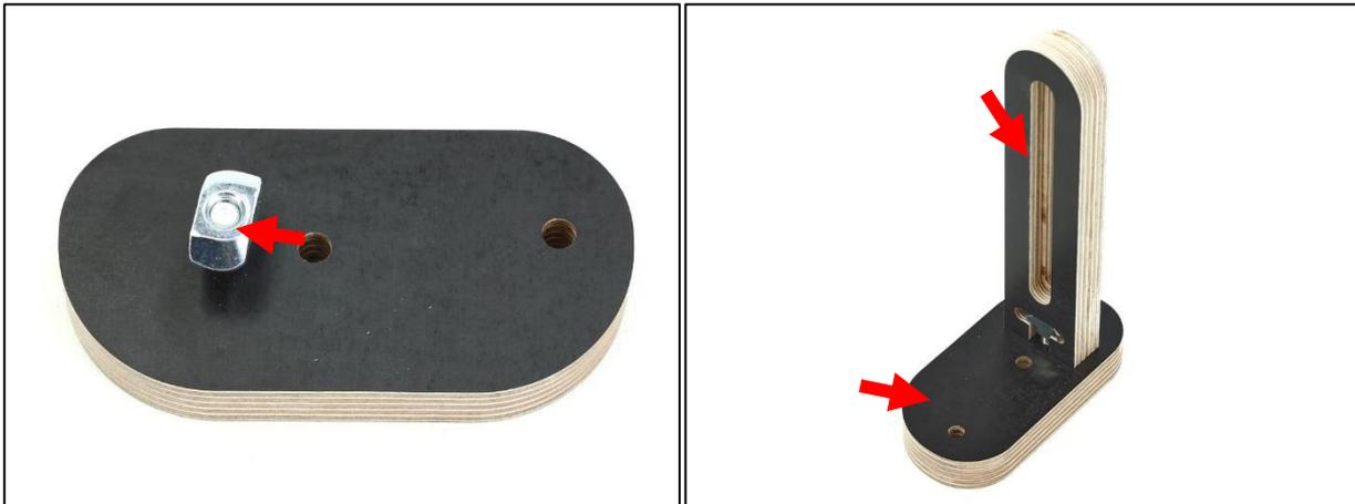
4. Abschließend wird eine Vierkantmutter in die rechteckige Aussparung in der Nähe des Teil-Q Logos eingesetzt. Die Fußplatte mit der montierten Höhenverstellung kann nun so angesetzt werden, dass der Schraubenkopf der Zylinderkopfschraube in der flachgesenkten Nut sitzt und die Flügelschraube mit der Vierkantmutter verschraubt werden kann.
