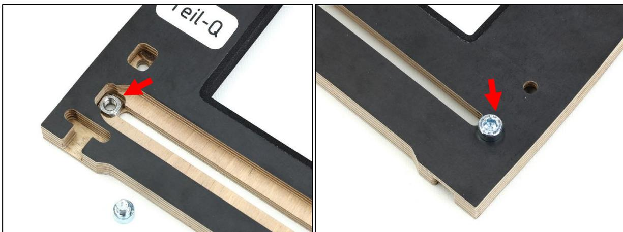
3. Bei der Fußplatte muss nun die montierte Flanschkopfschraube mit der Hammermutter in das äußere Loch versetzt werden. Anschließend kann das zusätzliche Bauteil der Höhenverstellung analog dem Seitenteil vom Q-Fix montiert werden. Dabei muss die flachgesenkte Nut zur längeren Seite der Fußplatte hinzeigen.
