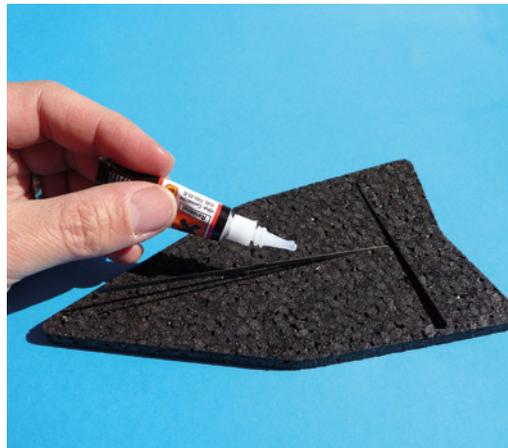
Selbst die Winglets haben bereits fertig abgelängte CFK-Verstärkungen.
