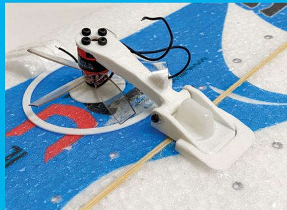
▲ ▼ Mein Eigenbau-Klapptriebwerk aus 3D-Druck-Teilen wird nur mit der Flügelschraube auf der Tragfläche gehalten und ist somit jederzeit abnehmbar. Der Regler sitzt im Rumpf, eine Kühlung ist nicht notwendig.
