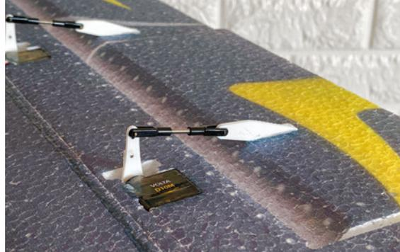
Die Anlenkung von Querrudern und Landeklappen erfolgt identisch. Dadurch kann man die Klappen 1:1 zum Querruder mitlaufen lassen.
