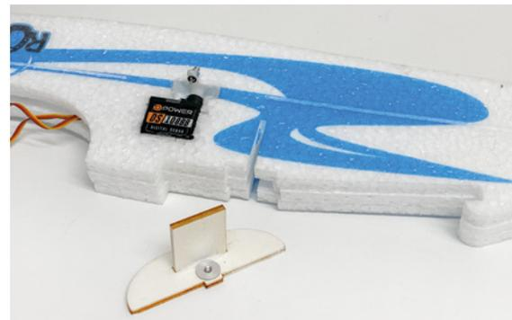
Trotz der kleinen Maße ist der Flügel des Rookie abnehmbar gestaltet. Die Kräfte werden über ein Sperrholz-Element in den Rumpf eingeleitet.
