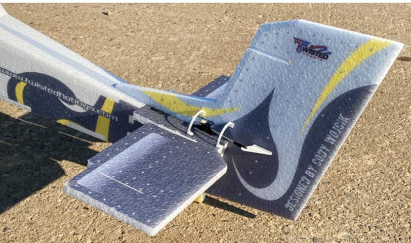
Um ein Einhängen der Schleppschnur an den Anlenkungen zu verhindern, habe ich noch diese Schutzbügel aus dem 3D-Drucker ergänzt.
