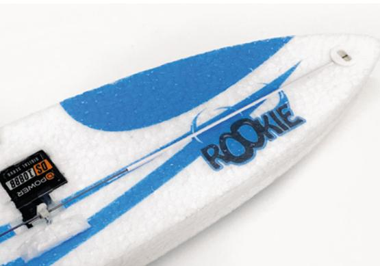
Die Rookie-Servos sind in Aussparungen in der Rumpfsseitenwand versenkt. Das Höhenruderservo bewegt zusätzlich den Draht für die Schleppkupplung.
