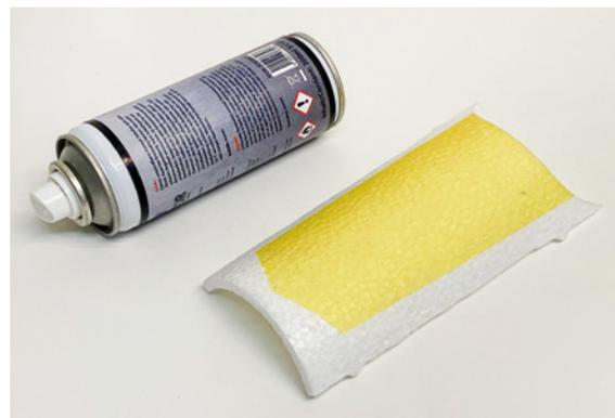
Die runden Elemente für Motorhaube und Scheibe des Jabberwocky habe ich mit Hilfe einer Aktivator-Flasche vorgebogen. Dann kann man sie spannungsfrei aufbringen.
