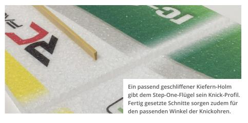
gibt keinen Flügel mit geschnittenem Profil. Das Hohlprofil der Fläche wird über ein simples Knicken der EPP-Platte erreicht. Und hier hat sich der Hersteller einen pfiffigen Trick einfallen lassen: Der Kiefern-Holm, der in eine Aussparung im Flügel eingesetzt wird, ist als Dreikant-Profil ausgeführt. So gibt der Holm automatisch den Knick des Flügels vor. Das Knick-Profil erstreckt sich dabei nur über das Flügel-Mit-
