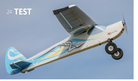
tern fliegt der Step One, als hätte er nie etwas anderes getan. Nach einem leichten Austrimmen lässt sich das Flugzeug praktisch nur mit Gas und Seitenruder fliegen. Der Antrieb ist dabei sehr gut abgestimmt. Das Modell steigt zügig auf Höhe, die Steigleistung und Geschwindigkeit überfordern aber auch einen Einsteiger nicht.
