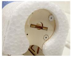
Markierungen auf dem Spant und gedruckte Abstandshalter sorgen beim Step 2 für den passenden Motorsturz und Seitenzug.
