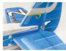
Das Step-2-Leitwerk wird über dünne Stahldrähte angesteuert. Sicherungsringe halten den abgewinkelten Draht und verhindern ein Herausrutschen.
