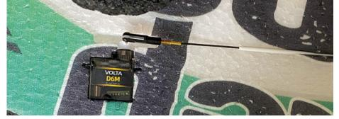
Die Servos werden am Step One bündig mit der Oberfläche in den Rumpf geschoben. Damit sind sie gut geschützt, aber leicht zugänglich.
