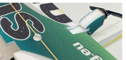
An der Flügelhinterkante ist der Antrieb des Step One perfekt geschützt. Dank der niedrigen Propellerdrehzahl bleibt der Druckpropeller akustisch angenehm.
