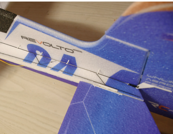
Das Seitenruder wird von einem CFK-Stab angesteuert. Dank der 3D-gedruckten Abstützungen ist diese Methode auch bei langen Wegen präzise.
