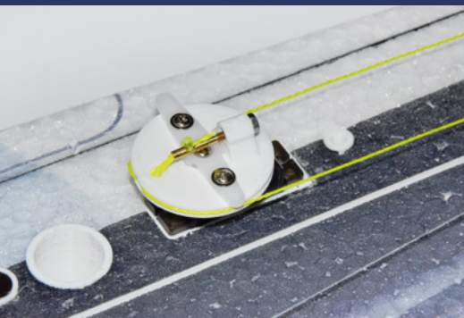
▲ Die Kugellager für das Pendelhöhenruder klebt man in die Wurzelrippe ein.
