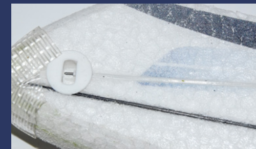
Der zweite Servoarm bewegt dann auf der anderen Seite die Schleppkuppelung. Raffiniert.
