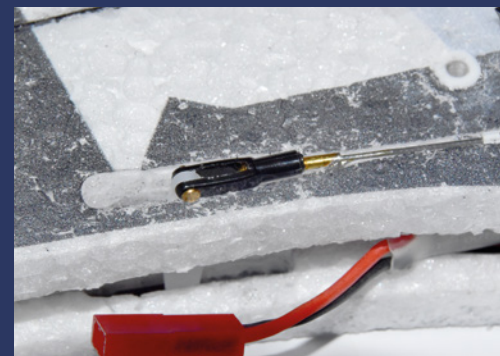
Die Anlenkung für das Seitenruder verläuft auf der einen Rumpfseite...
