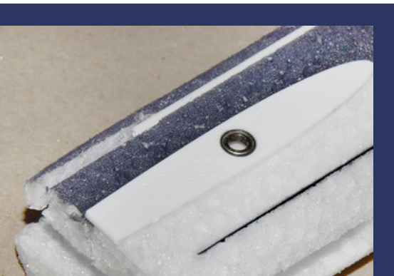
▲ Die Kugellager für das Pendelhöhenruder klebt man in die Wurzelrippe ein.
