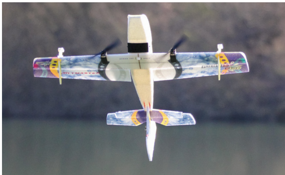
Die beiden Regler habe ich in der Mitte unter der Tragfläche positioniert. Direkt am Regler greife ich auch die Spannung für die Beleuchtung ab. Ein BEC-Stecker versorgt die LEDs im Rumpf.
