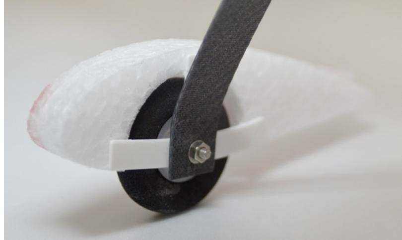
Das Fahrwerk ist ein laminiertes CFK-GFK-Bügel, der in einer 3D-gedruckten Aufnahme über 3-mm-Schrauben geklemmt wird.
