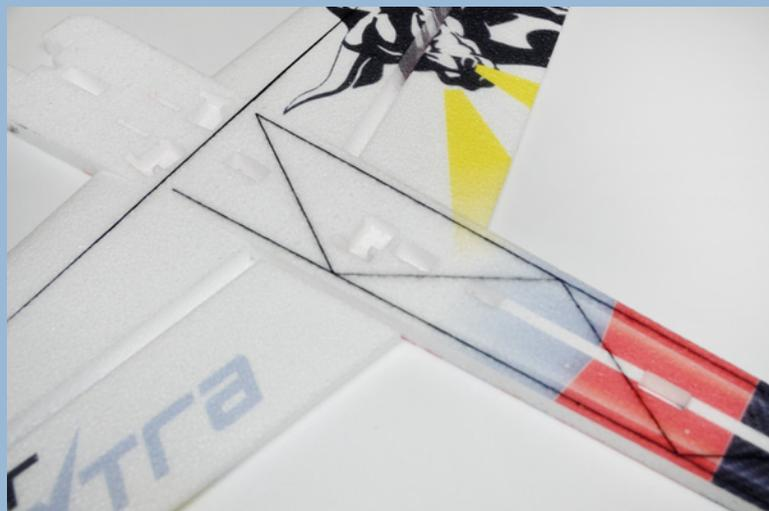
Das komplette Modell wird mit Kohlefaserflachprofilen wirksam ausgesteift.
