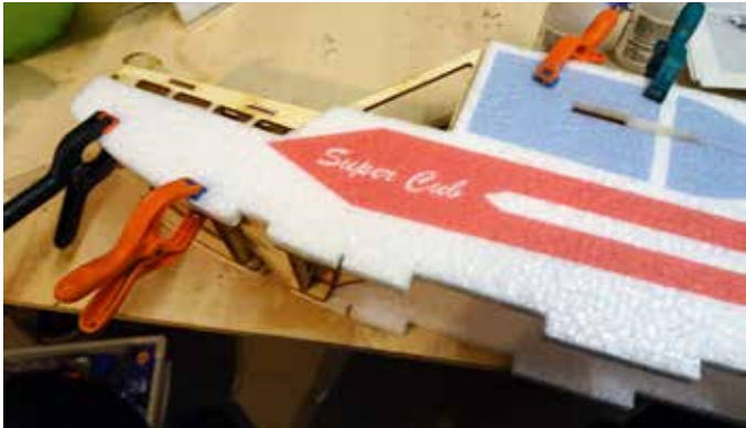
Beide Seitenwände werden mit dem Sperrholzskelett verbunden. Hier muss man darauf achten, dass keine Verzüge eingebaut werden
