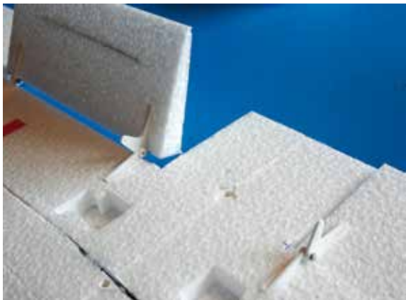
Da die Landeklappen nur optional sind, müssen sie vom Kunden selbst ausgeschnitten werden. Dem Bausatz liegen dafür benötigte Anlenkmaterialien sowie die Scharniere bei
