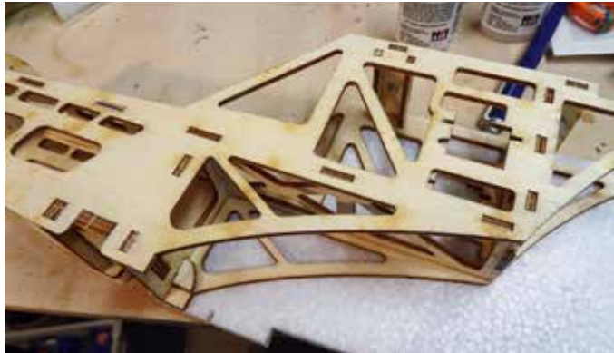
Das fertige Rumpfskelett verbindet Tragflächen, Motor und Fahrwerk sowie die EPP-Teile des Rumpfs miteinander
