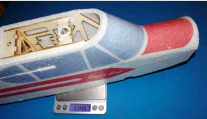
Die fertige Rumpfnase mit den beiden gebogenen Teilen der Motorhaube und der Kabinenverglasung
