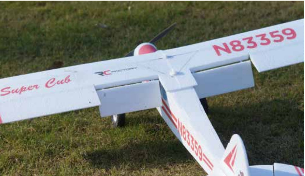
Klappen voll gesetzt. Eigentlich ist das viel zu viel Ausschlag, aber trotzdem interessant
