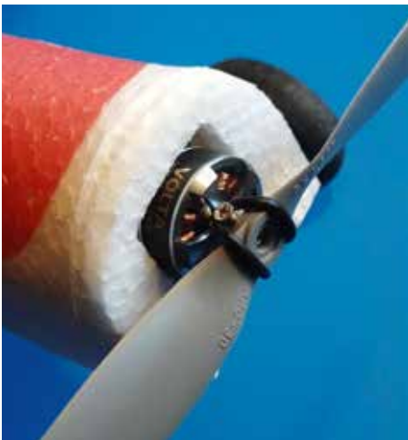
Der Propsaver mit O-Ring schützt den Propeller sehr wirkungsvoll
