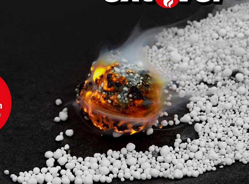
Durch Abdecken der Brandlast mit Extover® wird Sauerstoff verdrängt und vom Brennstoff getrennt. Wie Glas schmilzt Extover® ab einer gewissen Temperatur. Das Granulat nimmt dabei viel Wärme in Form von Schmelzenergie auf, kühlt damit den Brand ab und bildet gleichzeitig eine undurchlässige Hülle über der Brandlast. Eine Reaktion mit Sauerstoff wird effektiv verhindert.
