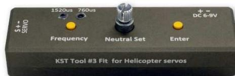
Vielen Dank, dass Sie sich für das KST Tool #3 entschieden haben. Mit dem KST-Tool #3 können Sie bequem und präzise die Mittelstellung eines Servos ändern, ohne dabei an Servoweg zu verlieren. Des Weiteren können Sie mit dem Tool #3 den Ansteuer-Impuls 760/1520  $\mu$ s ändern.
